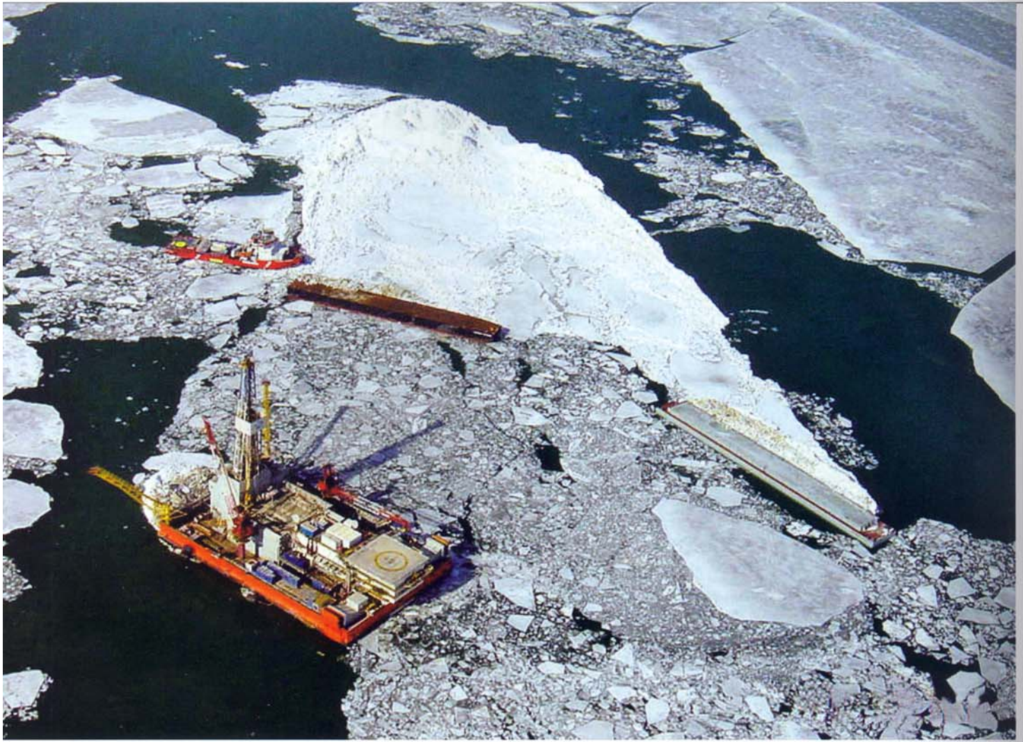
Abb. 3: Bohranlage mit Eisbarrieren
